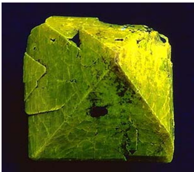
Zirkoon van Matonge, Burundi. Fluorescentie-opname. De barstjes in het kristal zijn het gevolg van metamictisatie. Foto en copyright Axel Emmermann. http://www.minerant.org/photoD/ae019.html
