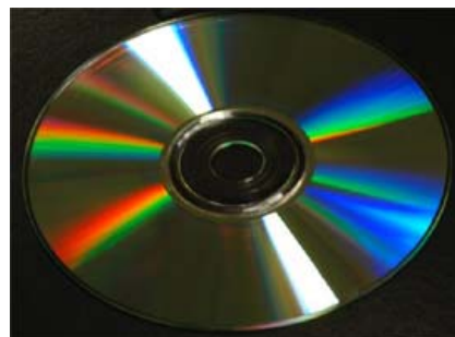
Figuur 5. Een CD heeft ook een fijn tralierooster. Je zou hiermee ook een spectroscop kunnen maken.
